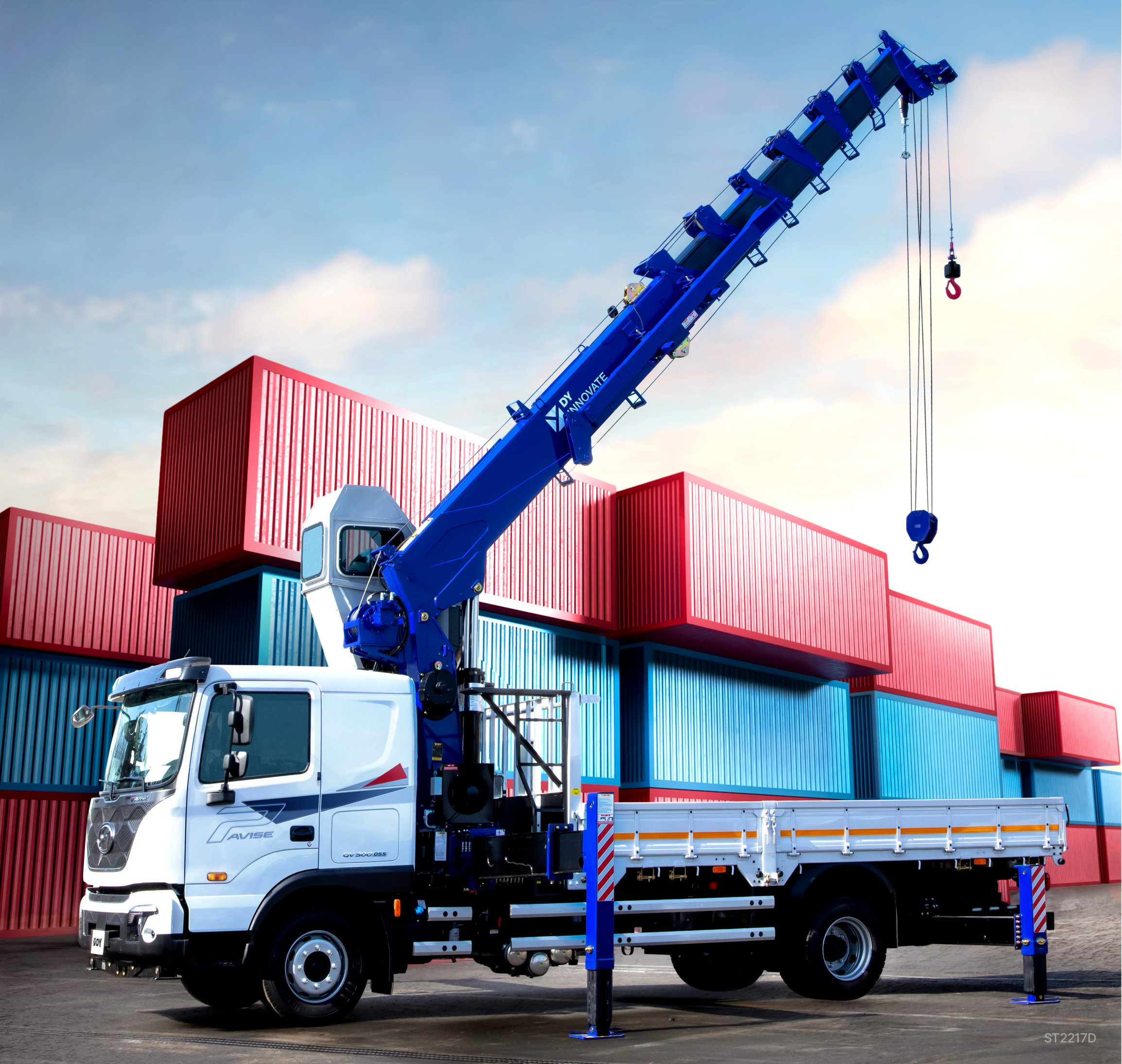
②와이어 정렬 장치 와이어 들뜸/꺾임을 방지하여 작동성 및 내구성을 향상시켰습니다 ③ 동급최대 아우트리거 크레인 흔들림을 최소화하여 작업의 안전성과 내구성을 극대화 하였습니다[사이드 확장 5M]
