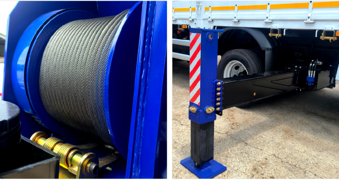
②와이어 정렬 장치 와이어 들뜸/꺾임을 방지하여 작동성 및 내구성을 향상시켰습니다 ③ 동급최대 아우트리거 크레인 흔들림을 최소화하여 작업의 안전성과 내구성을 극대화 하였습니다[사이드 확장 5M]
